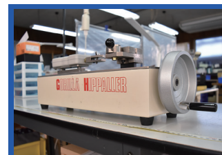
引っ張り試験設備
