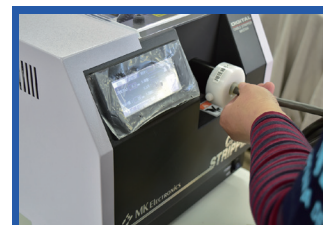
ストリップ設備（ジャケット）
